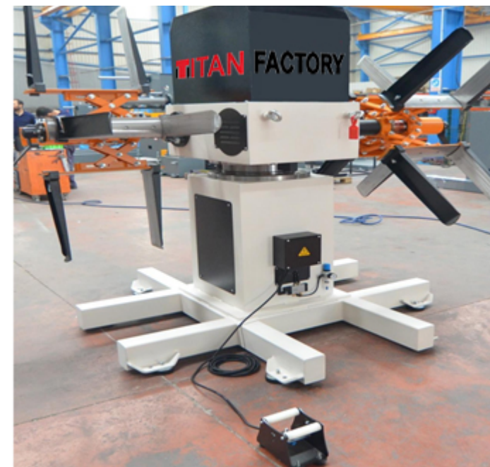
Bi-Dérouleur automatique orientable, Le double dérouleur permet de maximiser la production en réduisant les arrêts de production liés au chargement des bobines d'acier
