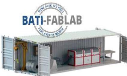
Dans nos ateliers ou sur site avec nos usines mobiles, nos robots mesurent, percent, taillent l'acier selon la modélisation de vos plans d'architecte. Chaque pièce est automatiquement numérotée pour un assemblage aisé
